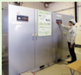
モータ試験装置 (200kW 級, 30,000rpm)
