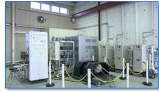
モータ試験装置 (200kW級、30000rpm)
