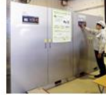
モータ試験装置 (200kW級、30000rpm)
