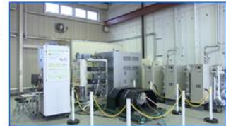
モータ試験装置 (200kW級、30000rpm)
